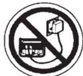
Подсоединение электростанции к электросистеме должно осуществляться только квалифицированным электриком и должно соответствовать всем электротехническим правилам и нормам. Неправильное подсоединение к системе может стать причиной выхода из строя электрогенератора, неисправности электросети и подключенных к ней электроприборов, а также привести к поражению электричеством людей.
