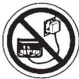
Подсоединение электростанции к электросистеме здания должно осуществляться только квалифицированным электриком и должно соответствовать всем электротехническим правилам и нормам. Неправильное подсоединение к системе могут стать причиной выхода из строя электрогенератора, неисправности электросети и подключенной к ней электроприборов, а также привести к поражению электричеством людей.
