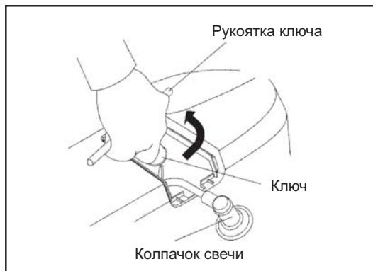
5. Осмотрите свечу на предмет повреждений. Если изолятор поврежден - замените ее. Прочистите свечу.
